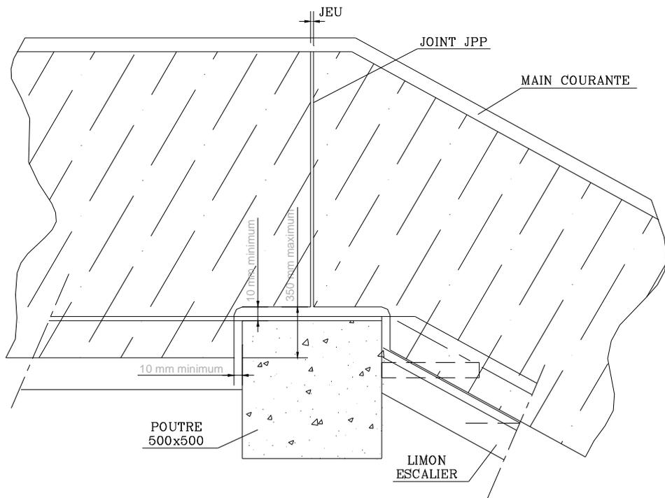
**Figure 13 – Cas d’une encoche (pour passage poutre)**
