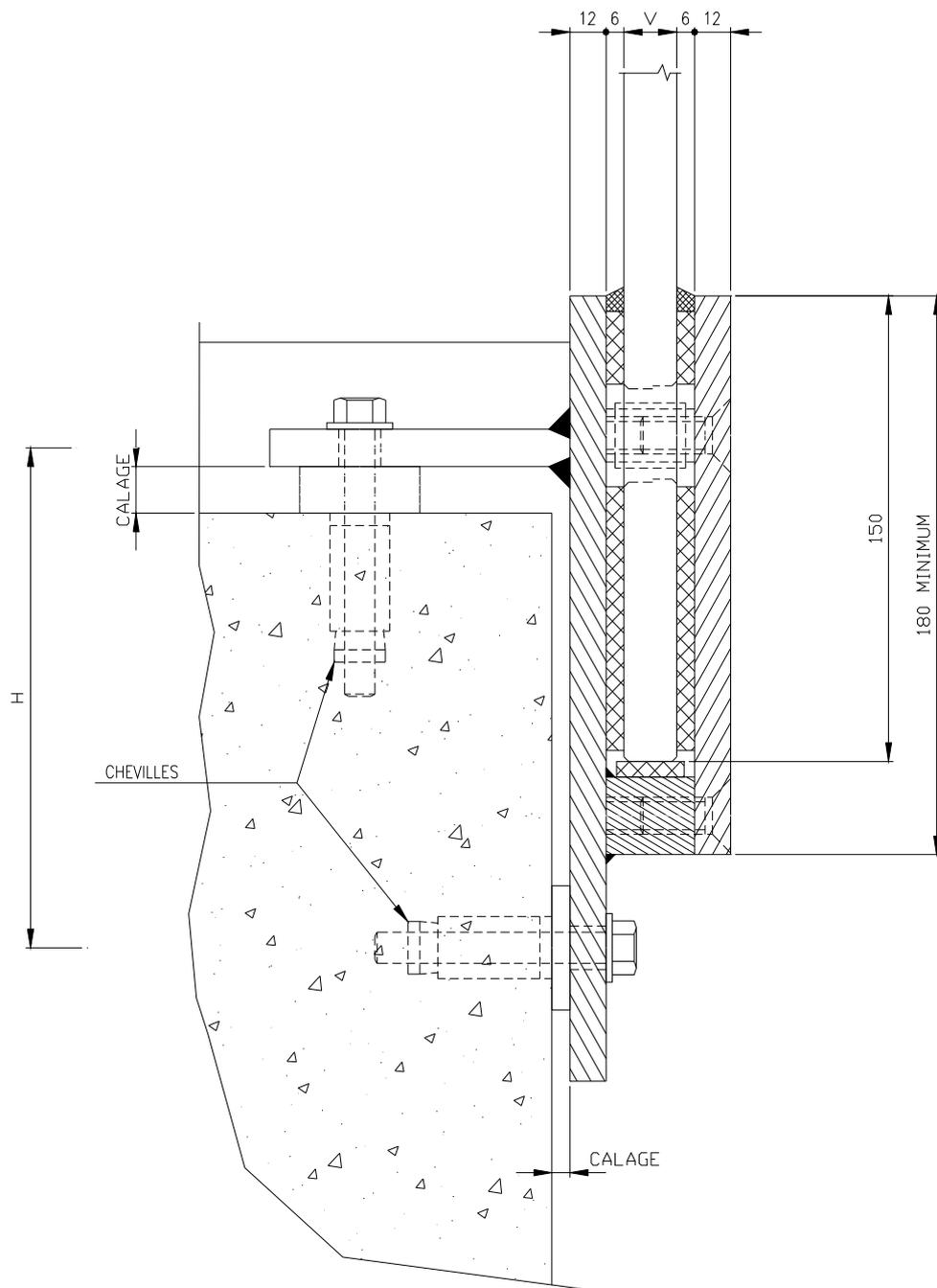
**Figure 8 – Fixation par plat acier**
