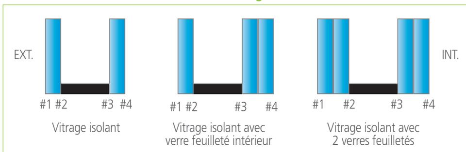
Le double vitrage est composé des éléments suivants :
