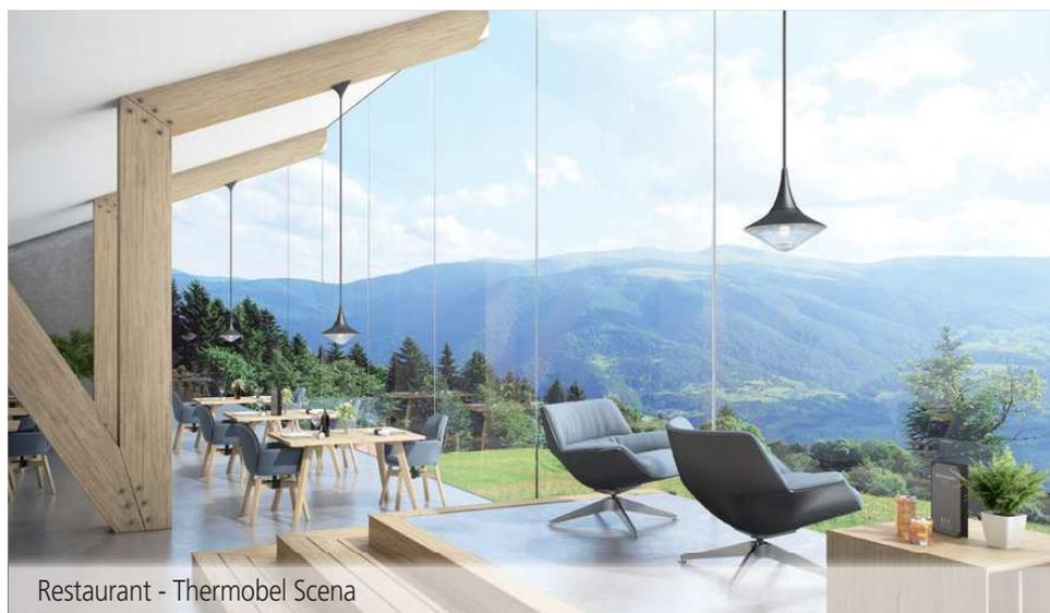
Thermobel Scena est un vitrage isolant intégrant des intercalaires verticaux transparents pour les montages de fenêtres ne nécessitant pas de meneaux (menuiseries verticales). Ce produit peut être assemblé avec toutes les gammes de verres à couche basse émissivité et de contrôle solaire.
